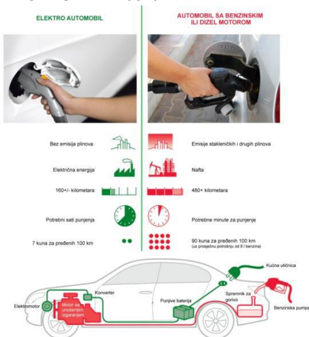
Slika: Sestavni deli voznega sistema - 100% električni avto Vir: CITROËN Hrvaška
